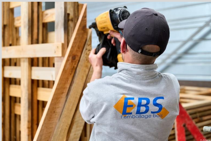
Assemblage de chevalets à Propières
